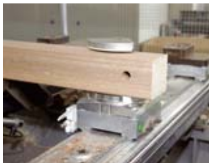
Bohren und Fräsen auf dem BAZ: Vor dem Profilieren lassen sich die Kanteln besser einspannen
