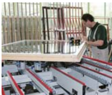
Alles an einem Ruchser-Arbeitstisch: Montage, Verklotzen und Beschlagmontage
