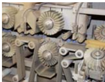
Schleifbürsten machen es möglich: Lackzwischen-schliff mit dem Leistomat LZ 8 von Löwer
