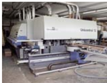
Die Weinig-Unicontrol-12 ist für 14 verschiedene Fenstersysteme bestückt
